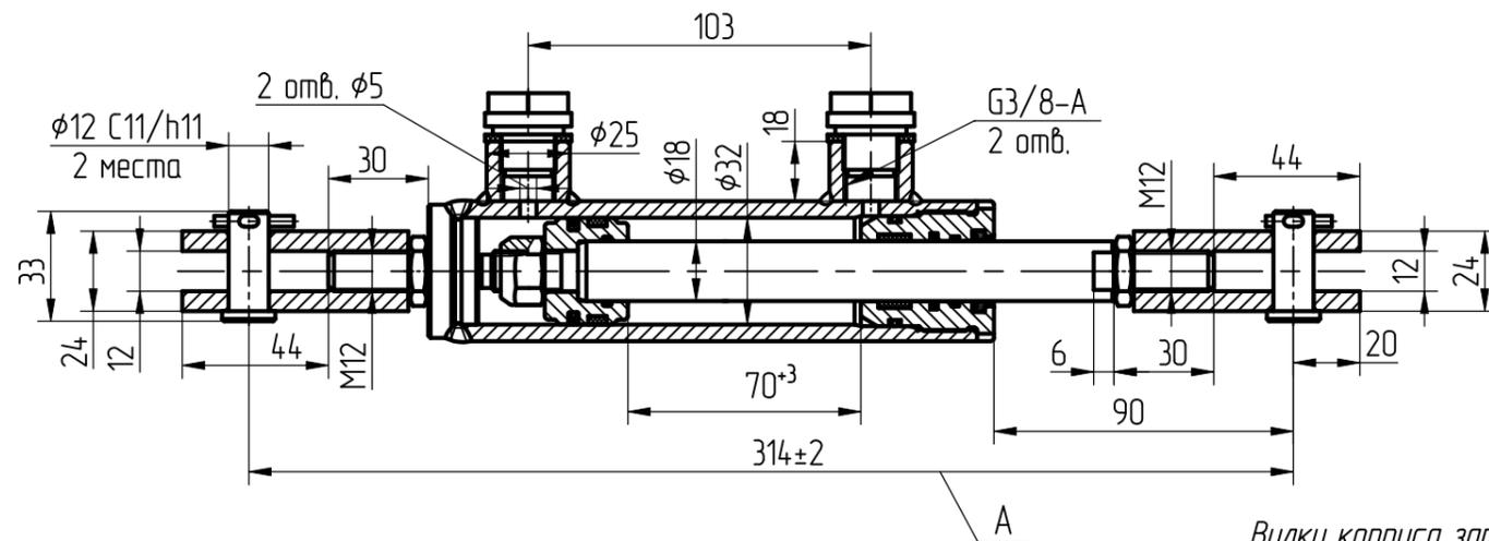
Вилку корпуса затянуть до упора, законтрив гайкой;
