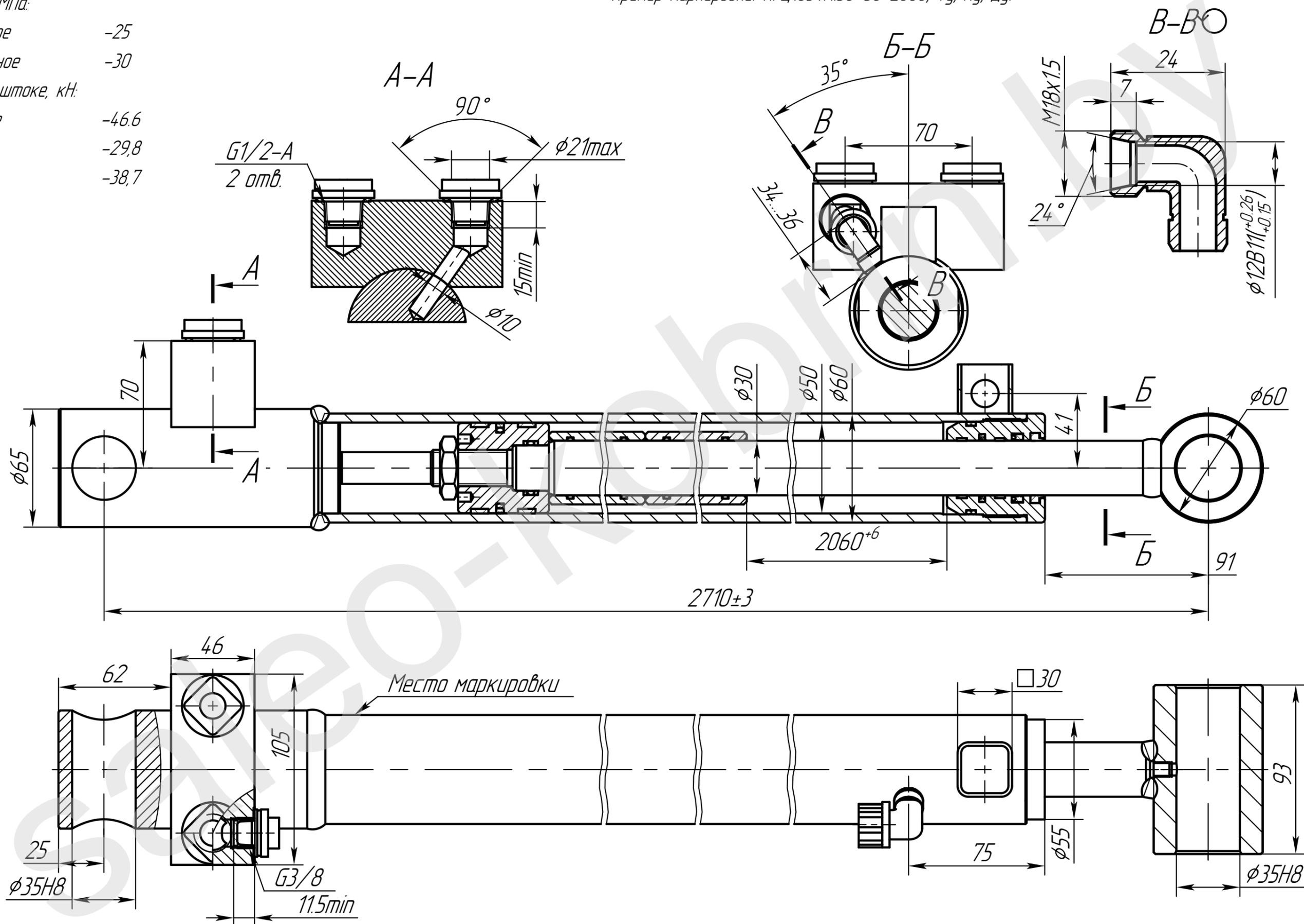
Применяемость: гидроцилиндр телескопической стрелы манипулятора КФ10080 производства ОАО "АМКОДОР".
