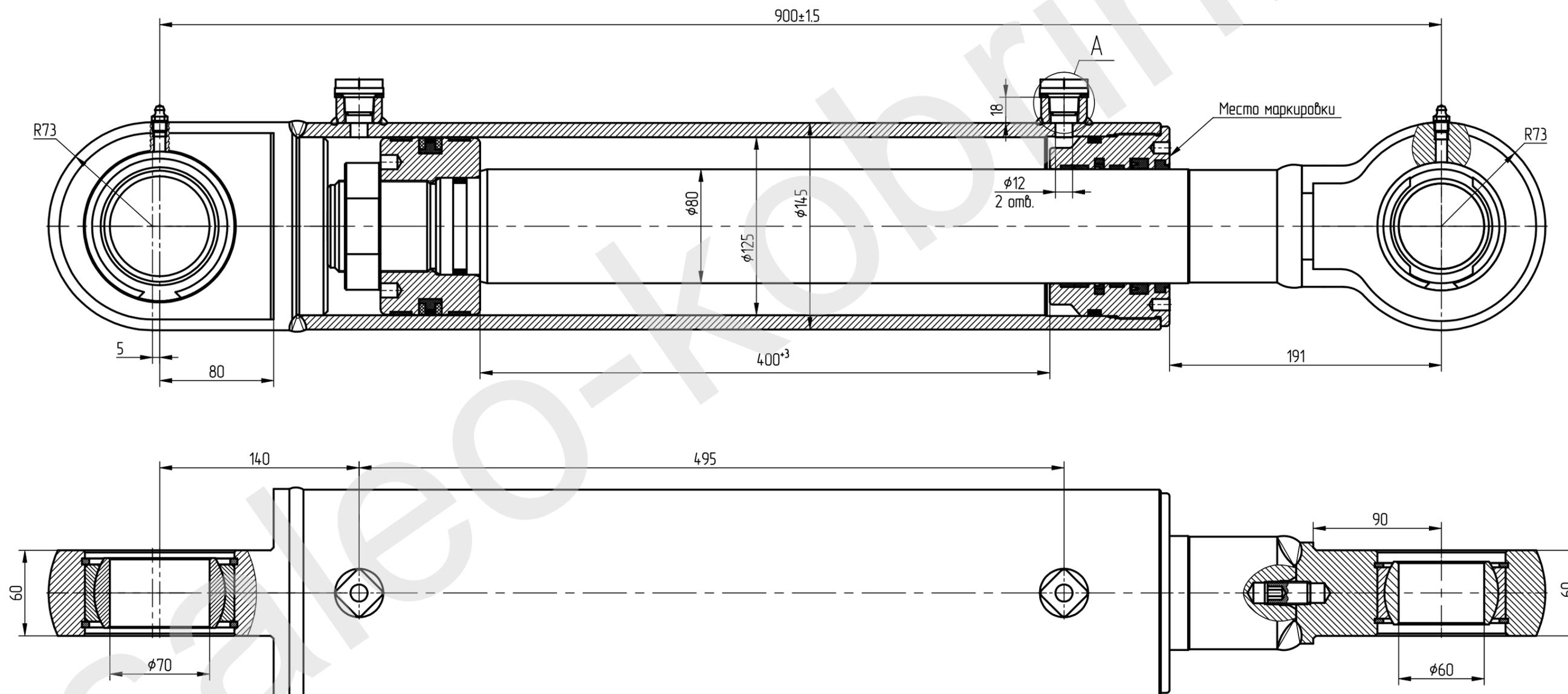
Применяемость: гидроцилиндр наклона манипулятора для харвестера подъема стрелы АМКОDОР FH3061.
