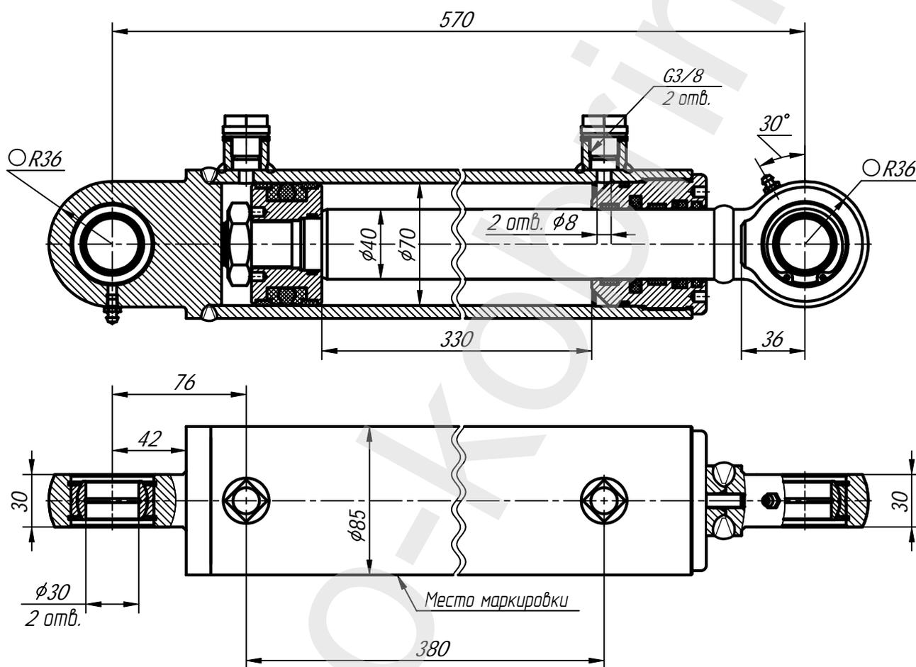
Применяемость: гидроцилиндр подъема стрелы машины коммунальной "АМКОДОР W100СМ".
