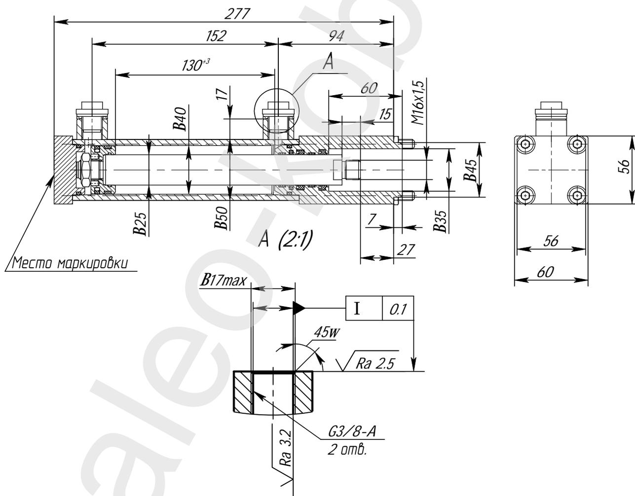
Применяемость: гидроцилиндр пильного механизма харвестерной головки НН630.
