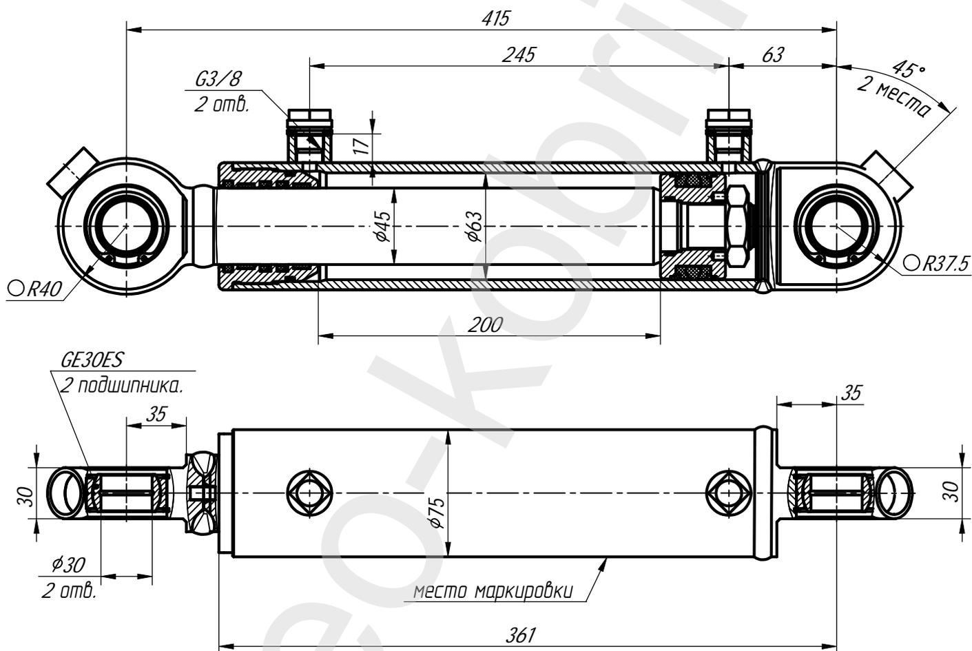
Применяемость: гидроцилиндр захвата для ОАО "ММЗ".
